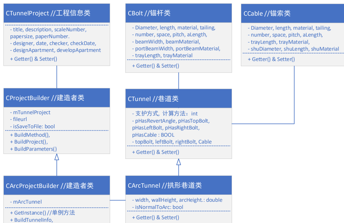
图 3 锚杆支护系统 UML 类图
